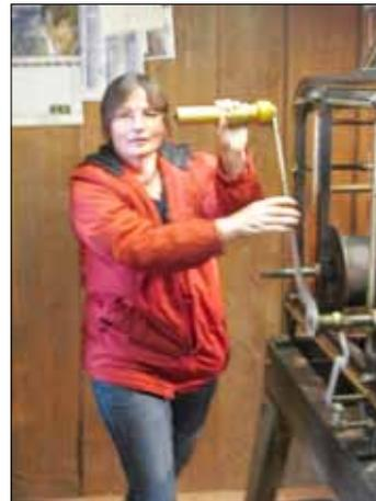
bewältigen und mit einer überdimensionalen Kurbel die drei Stahlseile für die Turmuhr und die beiden besonderen Schlagglocken immer wieder neu hochziehen.
